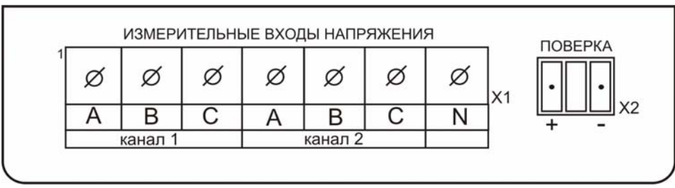
Рисунок Б.5 - Расположение элементов измерительного клеммного отсека приборов “Ресурс-ПКЭ-2.х-в”
