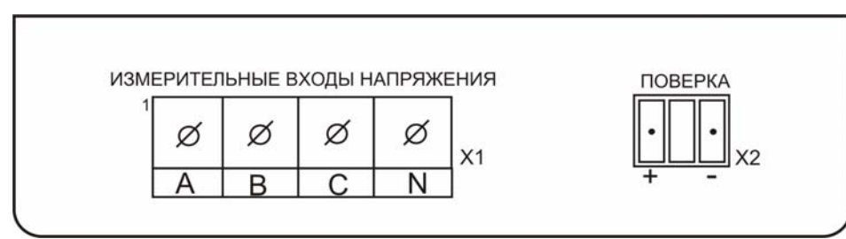
Рисунок Б.4 - Расположение элементов измерительного клеммного отсека приборов “Ресурс-ПКЭ-1.х-в”
