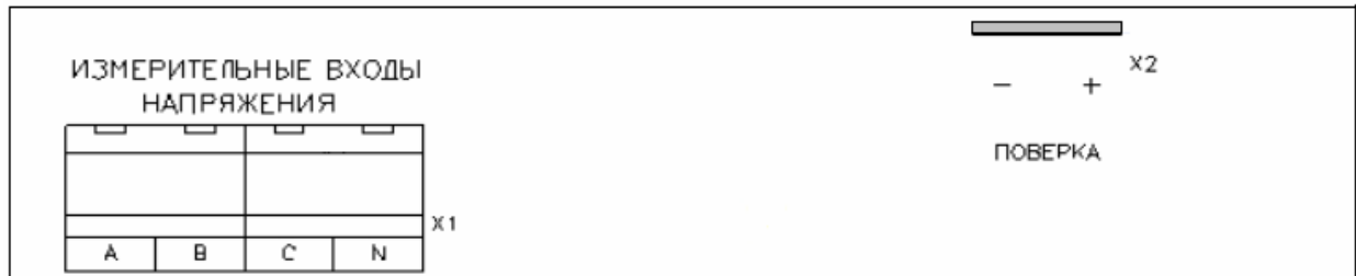
Рисунок Б.8 - Расположение элементов измерительного клеммного отсека приборов “Ресурс-ПКЭ-1.х-о”
