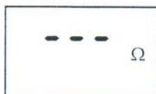
Рисунок 9 – Начальное меню для измерения сопротивления заземления
