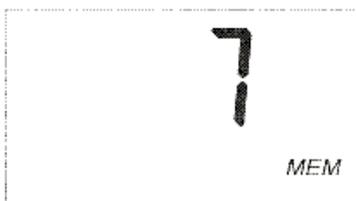
Код сохраненной функции (вращающийся переключатель в позиции 7 =  $R_{\pm 200\text{mA}}$ )
