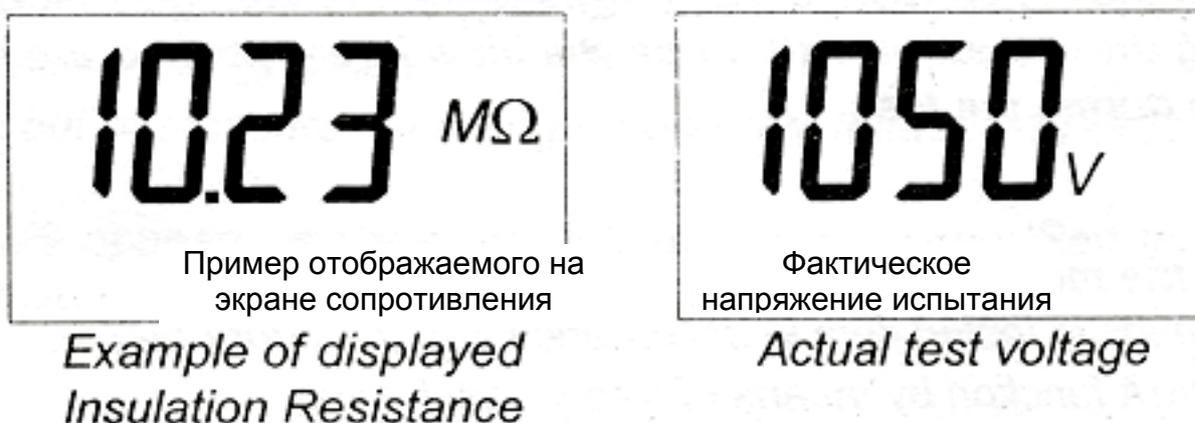
*Рисунок. 6. Пример отображенного на экране результата измерения*
