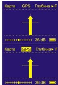
При нахождении точно над кабелем нажмите кнопку **F**, на экране отобразится глубина залегания трассы, координаты и номер записи. Запись измеренных данных в файл производится при **возврате** в режим «**КАРТА КАБЕЛЯ**» - кнопкой **F**.
