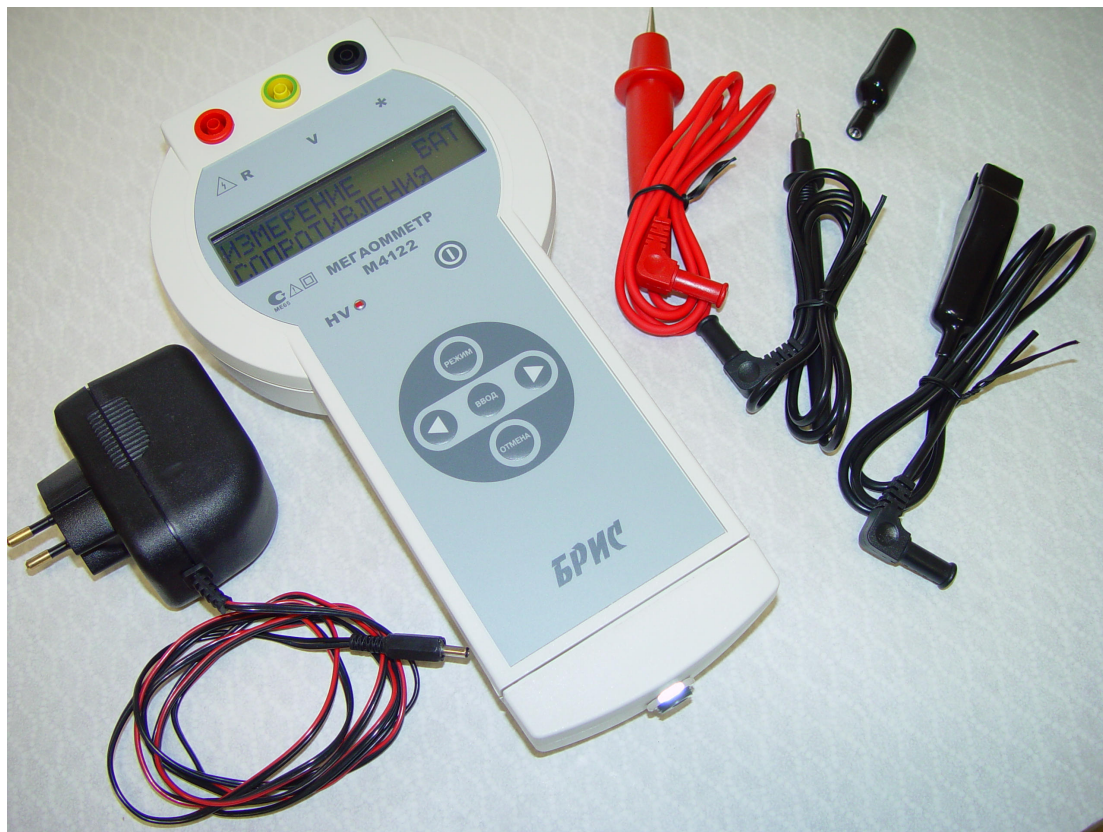
Рисунок 1 – Внешний вид мегаомметра, с сетевым адаптером и комплектом измерительных щупов.
