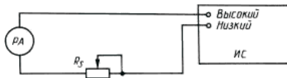
РА – амперметр постоянного тока; R_S – переменное сопротивление; ИС – испытуемый ЦИП; Высокий – импедансы. Низкий
